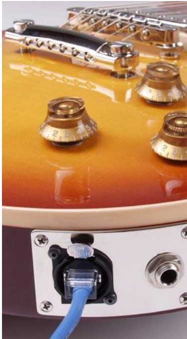
Fig. 18- Guitarras digitais com saídas analógicas convencionais e a saída digital para cabo de rede Ethernet.
