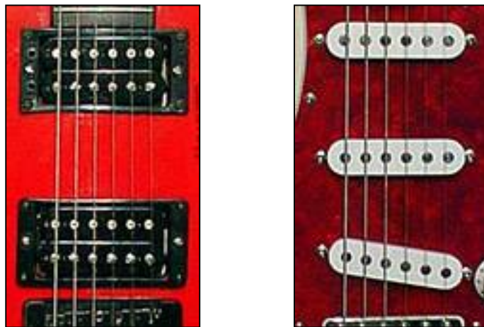
Fig. 6 -Guitarra com dois captadores de bobina dupla e outra com três captadores de bobina simples respectivamente.
