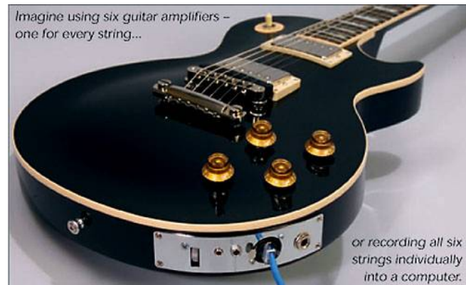
Fig. 18- Guitarras digitais com saídas analógicas convencionais e a saída digital para cabo de rede Ethernet.
